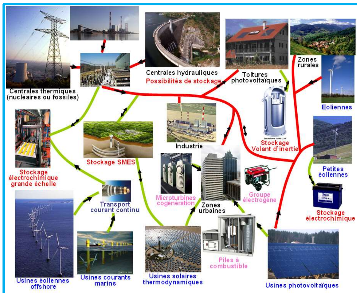
Figure 1.7 Mutation des réseaux vers une production plus décentralisée exploitant davantage les ressources renouvelables et les moyens de stockage (les réseaux de transport, de répartition et de distribution n'ont pas été distingués) [Mulon]
